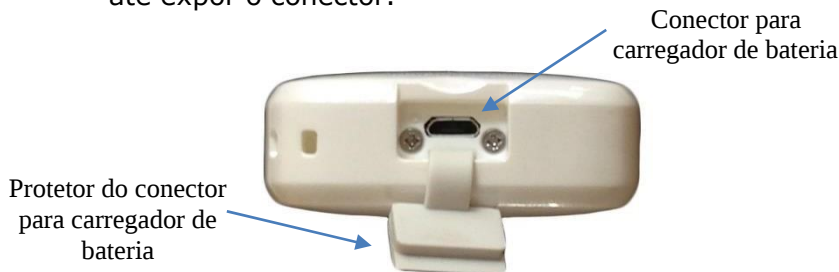
Figura 6: Detalhe do conector para carregar a bateria
