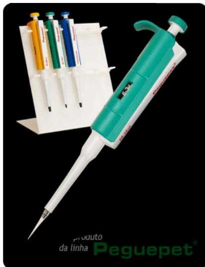
Micropipeta mecânica volume variável, com dispensador de ponteiras; visor com sistema de numeração digital ; formato anatômico, leve, feita em plástico ABS resistente. Parte inferior podendo ser autoclavada a 121 graus por um período de 15 minutos. A micropipeta já vem calibrada pelo próprio fabricante. Acompanha certificado de calibração e modo de uso.
