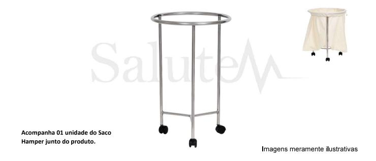
**ESTRUTURA:** Fabricada em Aço Inox, tubo redondo Ø 7/8" x 1,20 mm de espessura (ABERTURA FIXAÇÃO DO SACO), Aço Inox tubo, redondo Ø 3/4" x 1,20 mm de espessura (PÉS DE APOIO), com reforços radiais em Aço Inox, tubo redondo Ø 5/8" x 1,00 mm de espessura.
