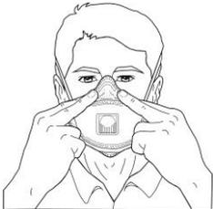
6. Coloque as pontas dos dedos de ambas as mãos na parte superior do clipe nasal (peça metálica recoberta). Deslize as pontas dos dedos por toda a extensão do clipe nasal, do centro para as extremidades, moldando-o de acordo com o formato do nariz. (Pictograma de atenção) Utilize as duas mãos para ajustar o clipe nasal. O uso de apenas uma das mãos pode causar um ajuste inadequado e prejudicar a vedação e o desempenho do respirador.
