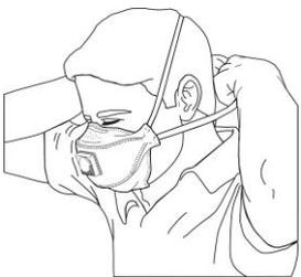
4. Puxe o elástico inferior, ajustando-o atrás do pescoço e abaixo das orelhas. Ajuste o elástico superior bem no alto da cabeça, acima das orelhas.
