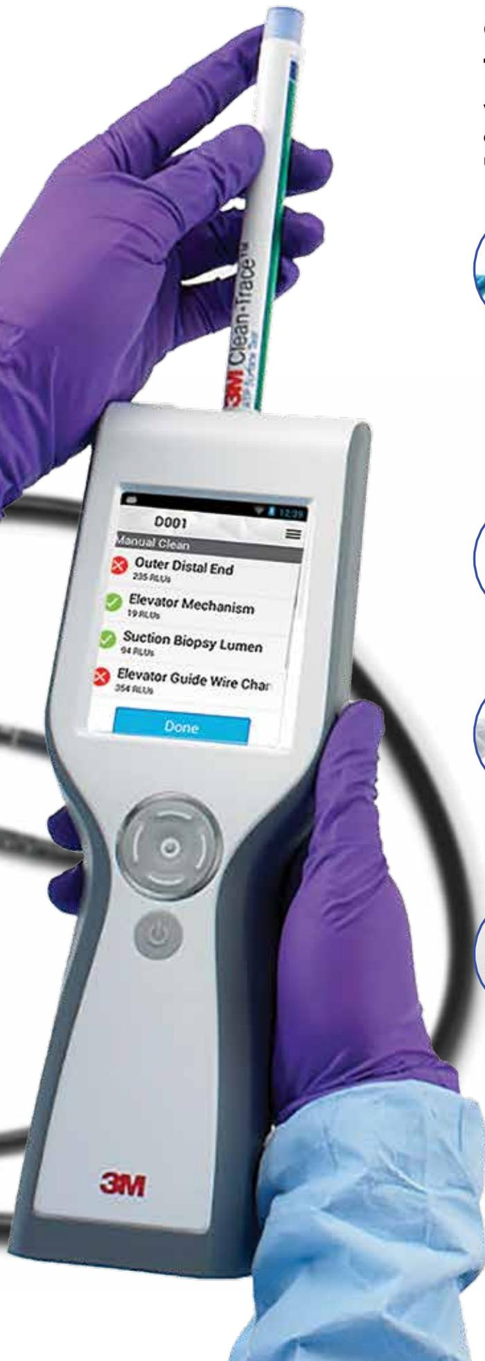
O Sistema Clean-Trace ATP oferece uma ferramenta de monitoramento de controle de qualidade para produtos para saúde difíceis de limpar, como os endoscópios flexíveis.
