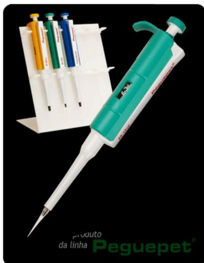
Micropipeta mecânica monocanal volume variável, com dispensador de ponteiros, visor com sistema de numeração digital; formato anatômico, leve, feita em plástico ABS resistente. Parte inferior podendo ser autoclavada a 121 graus por um período de 15 minutos. A micropipeta já vem calibrada pelo próprio fabricante. Acompanha certificado de calibração e modo de uso.
